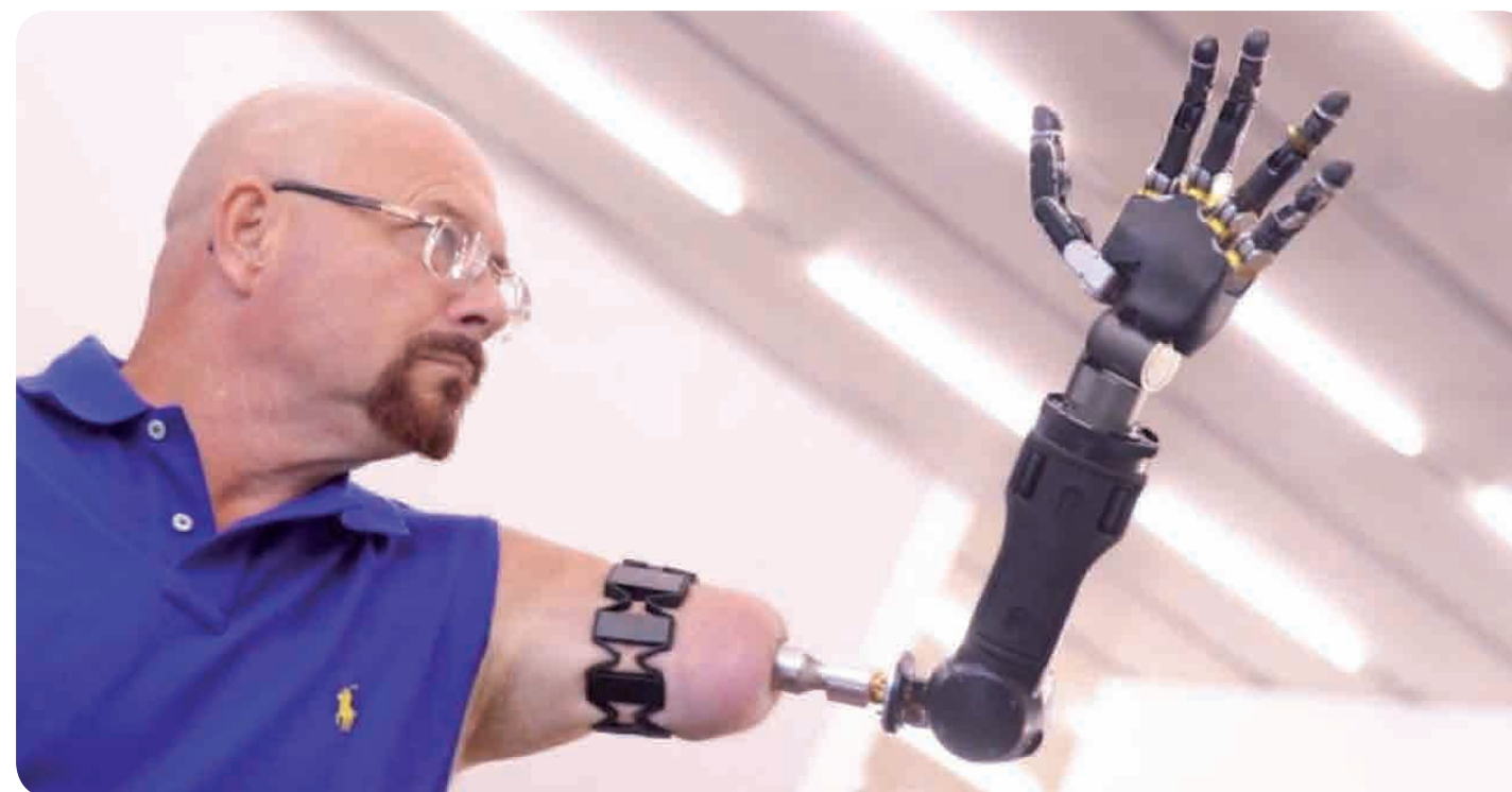
2. Johnny Matheny durante la sua sperimentazione clinica all'Applied Physics Laboratory dell'università statunitense Johns Hopkins, a Baltimora. Nella foto, si può ammirare il Modular Prosthetic Limb, l'arto artificiale protesico più complesso sviluppato ad oggi. Sul braccio di Johnny è disposto un bracciale costellato di sensori mioelettrici, utilizzati durante le sperimentazioni per controllare l'arto.
