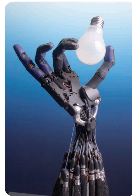
3. Shadow Hand, una mano robotica capace di produrre ben venti movimenti articolari differenti. Alla base dei tendini visibili in figura, si possono ammirare i venti attuatori (muscoli artificiali) responsabili dei movimenti articolari. In questo caso la "miniaturizzazione" della mano è resa possibile portando tutto il sistema di attuazione fuori dal palmo della stessa: ne risulta un ingombro/peso che non permette di utilizzarla come dispositivo protesico: si tratta di un arto artificiale, ma non di un arto protesico artificiale! Difatti, questo sistema è pensato per applicazioni industriali o per ricerca nel campo della robotica umanoide o della teleoperazione.
